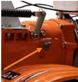
Fig. 5 – Verificarea nivelului de ulei al transmisiei
