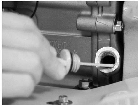
*Fig. 5 – Verificarea nivelului de ulei la motor*
