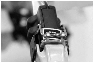
*Fig. 9 – Maneta de motor-stop*
