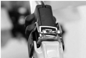
*Fig. 9 – дръжка за спиране на двигателя*
