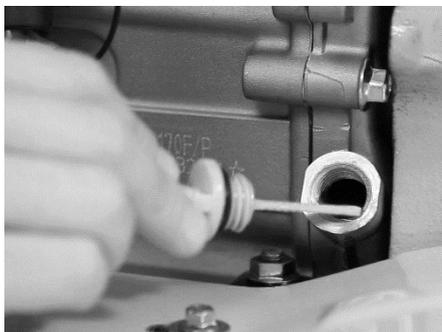
*5 –Ábra: Motor olajsintjének ellenőrzése*
