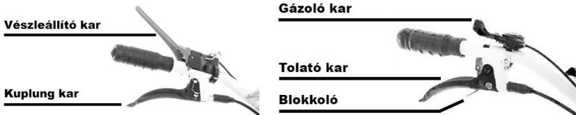
6 –Ábra- A kuplung kar beállítása és összeszerelése
