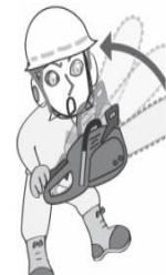
11. Fiți extrem de precauți când tăiați ramuri de dimensiune mică pentru că pot fi prinse în electroferastrău și aruncate spre dumneavoastră
