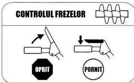
Maneta de control a frezei este situată pe mânerul din dreapta. Acționați maneta de control de pe mâner pentru a porni rotirea frezelor și a începe acțiunea de aruncare a zăpezii. Eliberați pentru a opri.
