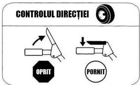
Maneta de activare a transmisiei este poziționată pe mânerul din stanga. Apăsați maneta pentru a începe deplasarea. Eliberați pentru a opri.
