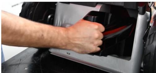
3. Placer la corde du démarreur sur le crochet de support.
