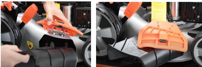
2. Verrouillez le trou de vidange avec le couvercle pour activer la fonction de mulching et de vidange latérale.
