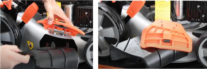
2. Se blochează cu capac orificiul de evacuare pentru activarea funcției mulching și evacuare laterală.
